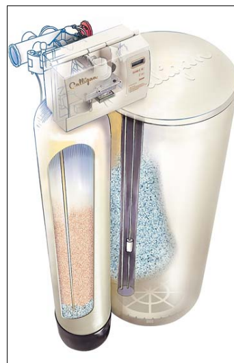
Waterontharder met het harsreservoir (links) en het zoutreservoir (rechts)
